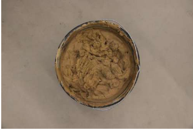
ZPRACOVÁNÍ HLÍNY S VODOU, PROSÉVÁNÍ PILIN (2mm)
